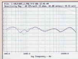
Απόκριση συχνότητας στο 1m και τα 50cm αντίστοιχα από το πλαϊνό τοίχο. Προσέξτε πως αλλάζει η συμπεριφορά του ηχείου στην περιοχή από 300 έως 1200Hz.
